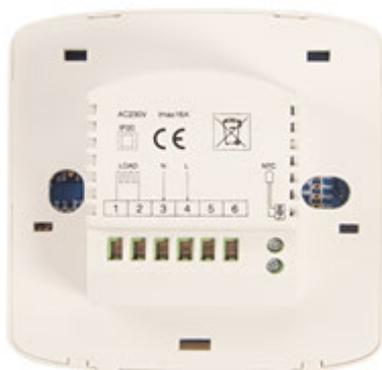
Для терморегуляторов «REXANT®» датчик температуры (NTC) подключается к клеммам 7 и 8. Переменное напряжение питания (220 В) подается на клеммы 3 и 4. Клеммы 1 и 2 предназначены для подключения выводов нагревательного мата к терморегулятору.
